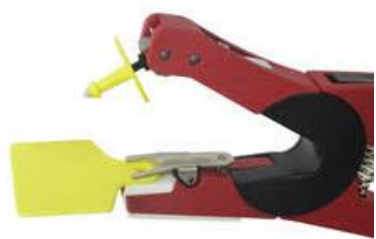
ຮູບທີ 11: ຮູບສະແດງການວາງບ້າຍໃສ່ເຄື່ອງໜີບຫຼຸດຢ່າງຖືກຕ້ອງ
